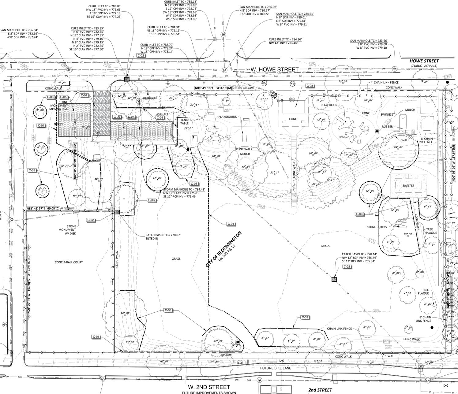
**4 EROSION CONTROL & TREE PROTECTION PLAN**
