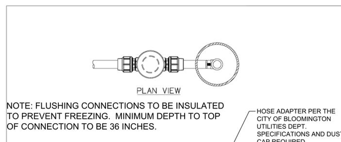
**TYPICAL TERMINAL FLUSHING CONNECTION**
